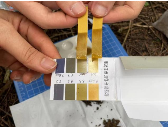
图 17 小组成员使用精密 pH 试纸测定古红土土层酸碱度 (图源：小组成员白玛德庆同学摄)
