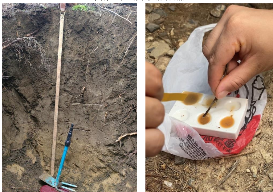
图 10 卷尺与土铲的使用&瓷盘与 pH 试纸 (图源：庐山实习期间自摄)
